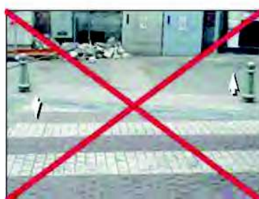
Figure 7: les dalles à protubérances doivent toujours être perpendiculaires à l'axe de la traversée. © GAMAH
