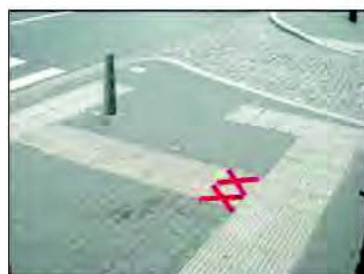
Figure 9: l'espace entre deux bandes de stries doit être de 30 cm ! © GAMAH
