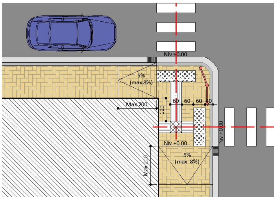
*Inflexions perpendiculaires en amont et en aval des 2 traversées + barrière protectrice à l'angle du trottoir*
